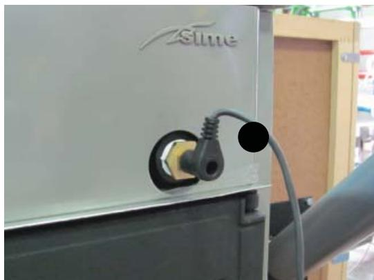
Fig. 34 Connettore termostato di sicurezza
