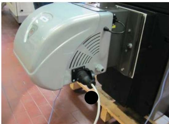
Fig. 33 Cavo motore coclea
